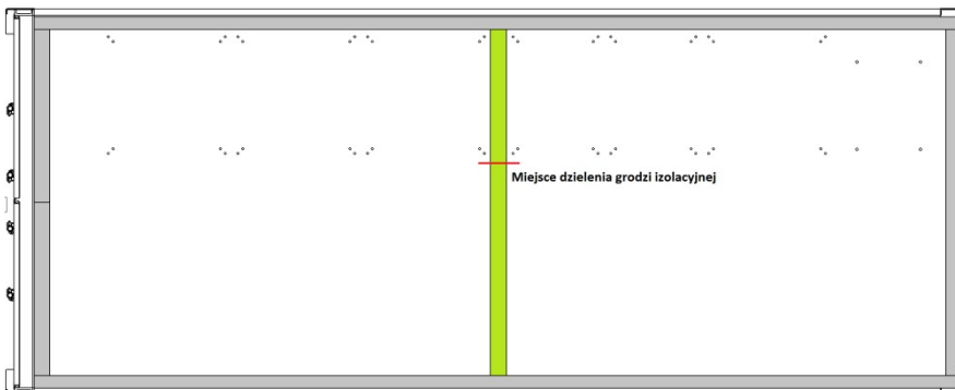
Rysunek 3: Widok poglądowy kontenera wewnątrz (podłoga). Propozycja rozmieszczenia otworów mocujących szaf sterowniczych do podłogi kontenera
